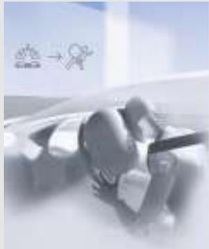
Nach 30 Millisekunden ist der Airbag prall aufgeblasen und kann die Insassen schützen. Foto: Bosch
