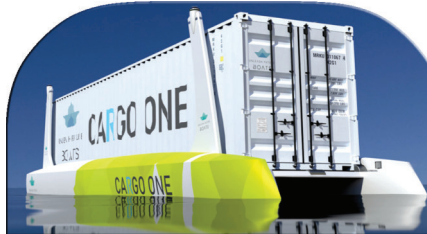
Die Variante „Cargo One“ soll als autonom und emissionsfrei fahrender Container-Carrier wie ein Lkw auf dem Wasser in Häfen eingesetzt werden. Foto: Grafik: Unleash Future Boats
